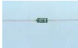
Cuando se le aplica una polarización directa al diodo PIN, conduce corriente y se comporta como un interruptor cerrado. Si se le aplica una polarización inversa se comporta como un interruptor abierto, no dejando pasar la señal.
